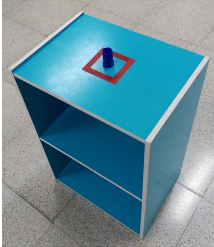
圖 6.4.3 紅色方框示意圖 長 x 寬 x 厚度：10x10x1.6cm，中心處有筆蓋固定於層櫃上
